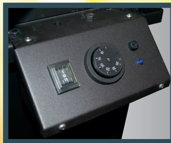
Armoire de commande et régulation
